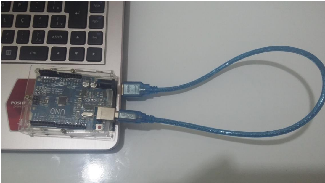
Figura A.3 – Conexão do Arduino com o computador através do cabo USB.
