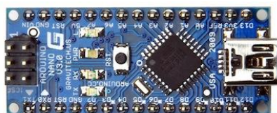
Figura 3.3 – Arduino Nano. Fonte: Extraído de Arduino Products (2016)
