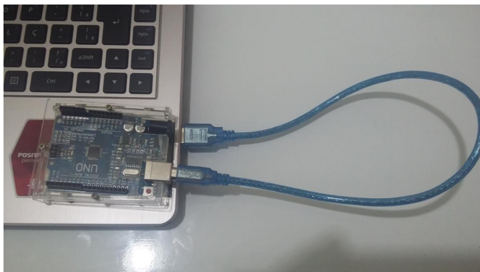
Figura 3.6 – Conexão do Arduino com o computador através do cabo USB.
