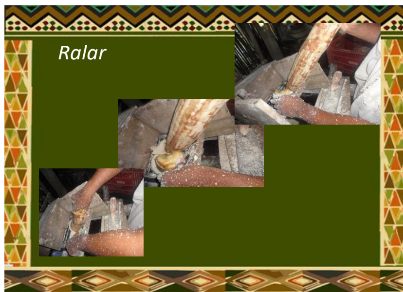
Imagem 6.2.5.14 Alguns procedimentos para produzir farinha de mandioca (ralar- “cevar”)
