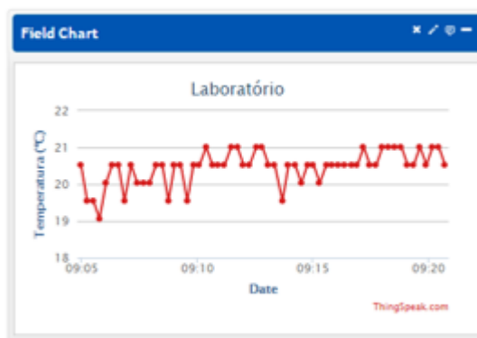
Figura 50: Leitura do canal 1 do LM35.
