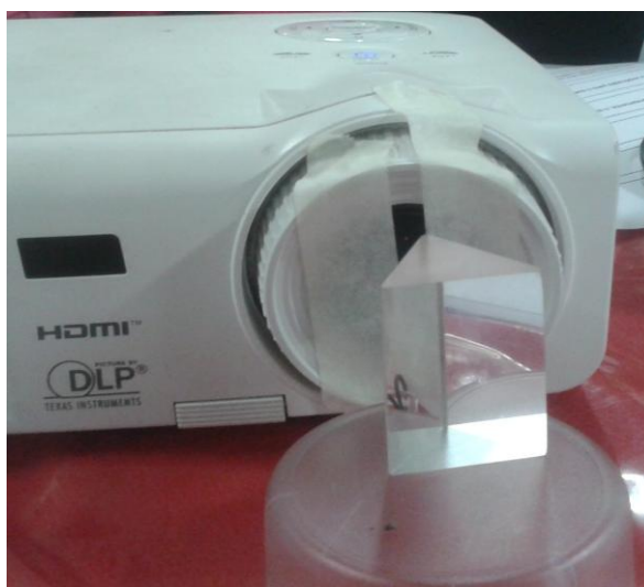
Figura 13: Vista da fenda feita com fita crepe e do posicionamento do prisma.
