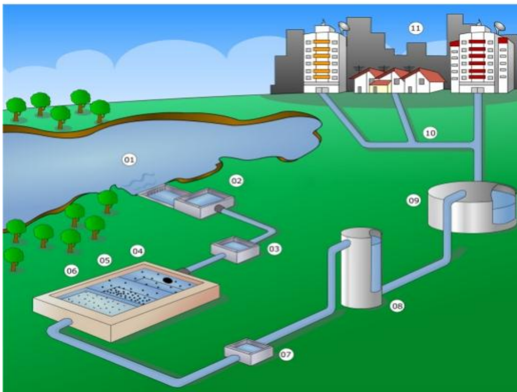
Figura 1: Etapas de uma Estação de Tratamento de Água (ETA)
